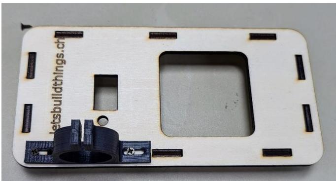
2. Montieren Sie den Motorhalter auf das Chassis. Fixieren Sie ihn leicht mit zwei Schrauben. Der Halter muss später noch genau positioniert und dann fest fixiert werden.
